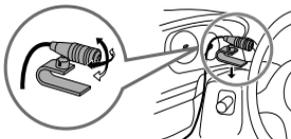
Asegúrelo mediante abrazaderas para cable (no suministradas) si fuera necesario.
