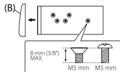
⚠ Utilice solo los tornillos especificados. El uso de tornillos incorrectos puede dañar la unidad.
